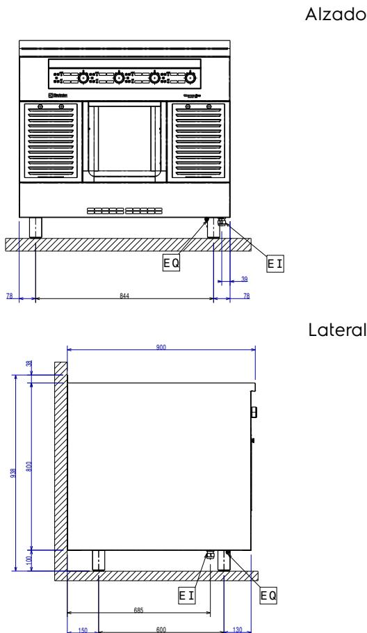
**EI** = Conexión eléctrica (energía)
